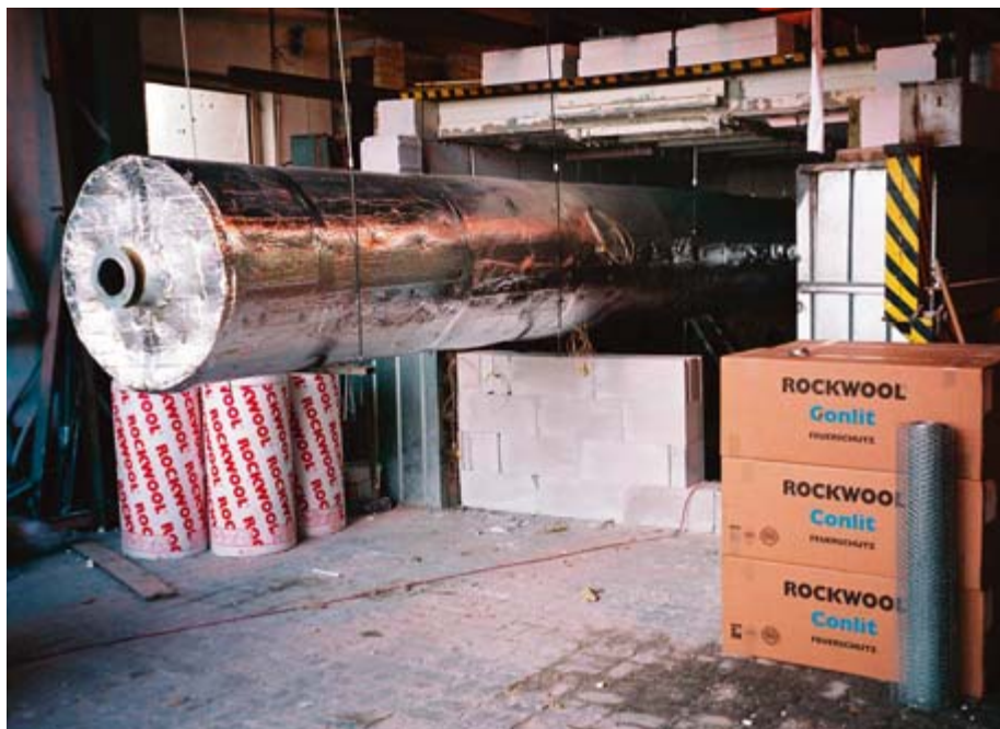
Obr. 6 – Vodorovné potrubí izolované systémem PYROROCK ve zkušební peci
