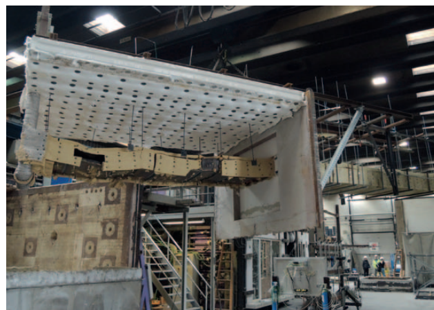
Obr. 81 Pohled na potrubí typu C po 120 minutách působení normového požáru
