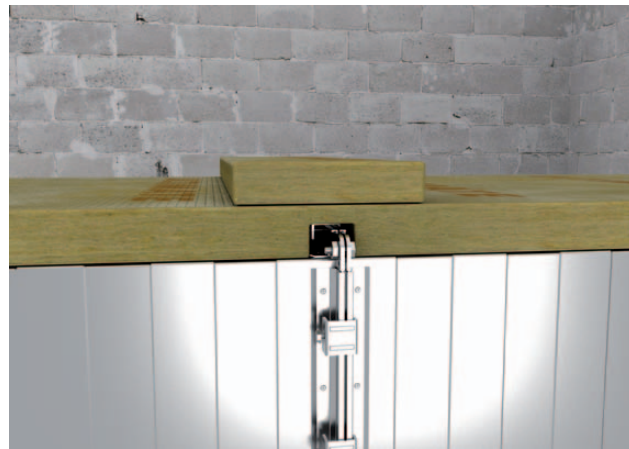
Obr. 78 Je-li použita izolační deska o tloušťce izolace \leq 50 mm, nad přírubu se umístí pásek druhé vrstvy izolace o min. tloušťce 30 mm a šířce 150 mm
