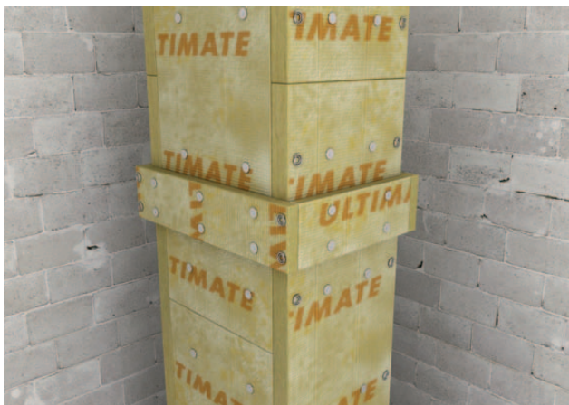
Obr. 79 Rozmístění trnů a vrutů Fire Screw u přidavné druhé vrstvy izolace
