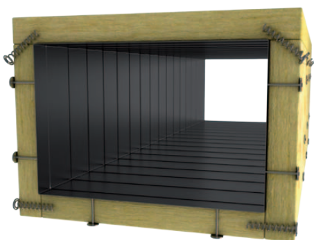
Obr. 42 Horní deska překrývá boční desky, které překrývají spodní desku
