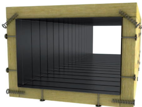
Obr. 71 Horní deska překrývá boční desky, které překrývají spodní desku
