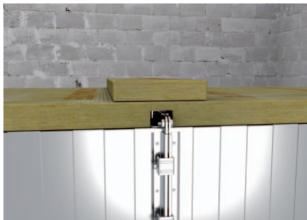
Obr. 47 Je-li použita izolační deska o tloušťce \leq 50 mm, nad přírubu se umístí pásek druhé vrstvy izolace o min. tloušťce 30 mm a šířce 150 mm
