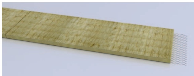
Obr. 61 Přesah pletiva 100 mm je nutný kvůli podélnému spojení rohože
