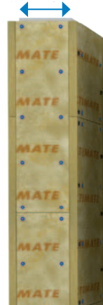
Obr. 76 Rozmístění trnů a vrutů u svislého potrubí
