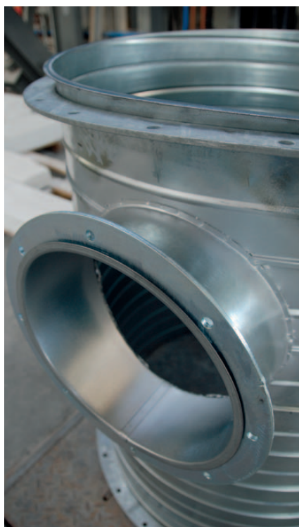
Obr. 32 Pohled na spiro potrubí spojené přírubami před montáží
