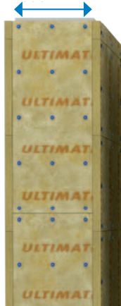
Obr. 76 Rozmístění trnů a vrutů u svislého potrubí
